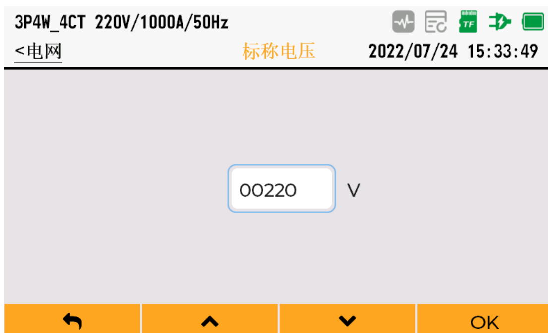
圖 5-7 標稱電壓配置
